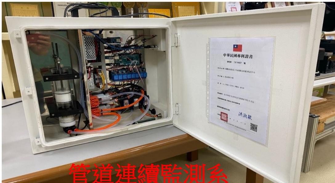
管道連續監測系統(量測VOCs)
